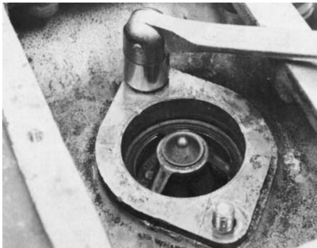
**17b.** Version B. Déposez le couvercle du boîtier de thermostat et retirez le thermostat pour le contrôle de la température d'ouverture.
