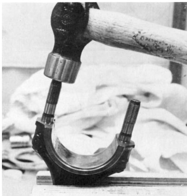
**45. Montage de nouveaux pistons.** Poser un circlips (4). Chauffer le piston jusqu'à environ 80°C. Monter la bielle de telle manière que le chiffre d'identification (1) soit tourné du même côté que « le trèfle » (2) du piston. Enfoncer l'axe de piston (3) en place et monter le deuxième circlips. Mettre ensuite les demi-coussinets dans la bielle et dans le chapeau de bielle. Veiller à bien positionner les demi-coussinets. Lubrifier le piston et les portées de paliers.
