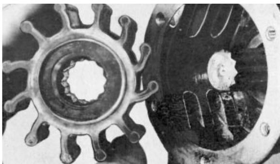
**80b.** Version B. Démontez et rénovez la pompe à eau de mer. Déposez le couvercle et extrayez la roue hors du carter à l'aide de deux tournevis. Faire attention à ne pas endommager les bords du carter.
