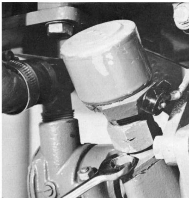
**119.** Monter le conduit entre le radiateur d'huile et la pompe à eau de mer. Bien serrer les colliers de serrage.
